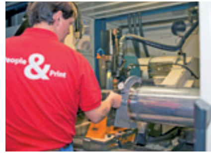
Höchste Präzision bei KBA in Würzburg: Messen, tauschen, schleifen der Schmitzringe.
